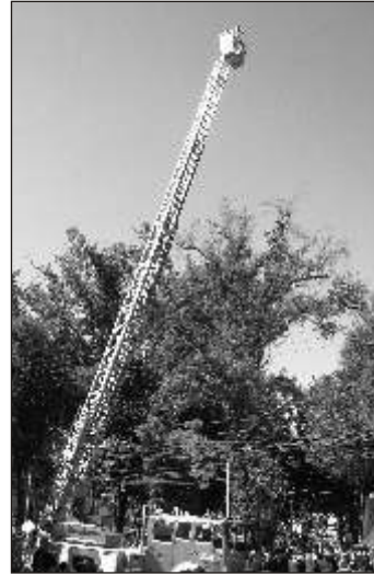
En la imagen la escala telescópica con un alcance de 35 mts. permitirá un mayor radio de acción.
